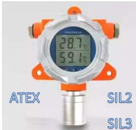
GE-373-Ex 防爆型温湿度变送器由香港艾伊特公司设计制造，采用隔爆外壳，对易燃点与外界气体和粉尘进行隔绝处理，具有国内和国际 ATEX 防爆证书，量程有多种可选，信号输出可以是 4-20mA 或者 RS-485.同时满足气体防爆和粉尘防爆要求. 燃气防爆标志：ExdIICT6 或者 ExdIIBT4 BT6；粉尘防爆标志：ExtbIIIC T85℃, Ex tD A21 IP65 T80。另外，此产品可提供 SIL2 SIL3 安全级别认证证书。
